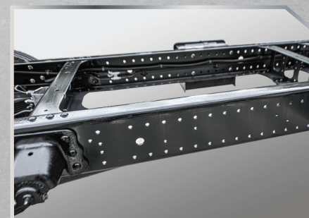
Khung gầm với mạng lưới lỗ đồng đều, thuận tiện đóng thùng
