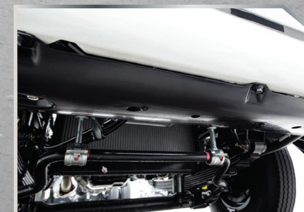
Gầm Cabin được trang bị tấm bảo vệ
